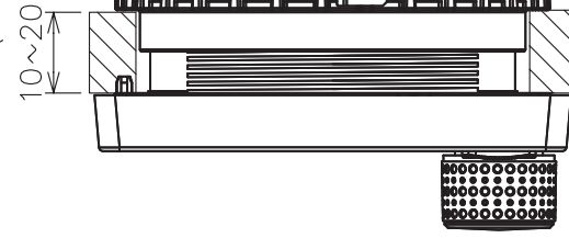
取付穴寸法図 (壁厚10~20m用) CUTOUT DIMENSIONS (BULKHEAD: 10 TO 20)
